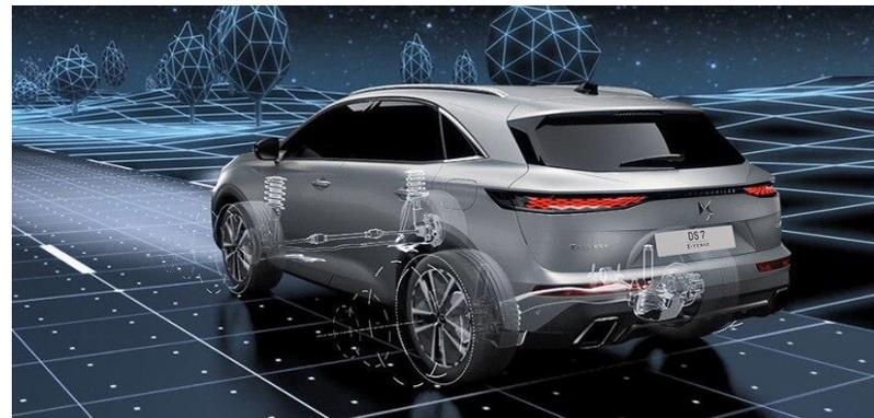
Este sistema de suspensión inteligente utiliza una cámara situada en la parte superior del parabrisas, así como varios sensores, para explorar las imperfecciones de la carretera en tiempo real. Este sistema transmite estos datos en milisegundos a un ordenador que actúa sobre cada una de las ruedas de forma independiente. En función de la información que recibe, endurece o ablanda continuamente la suspensión para garantizar el mayor confort posible al conducir el DS 7.
