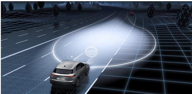
En beneficio de su seguridad, los faros inteligentes DS PIXEL LED VISION 3.0 se adaptan a su entorno ajustando la iluminación en función de las condiciones exteriores (ciudad, campo, clima, etc.) y dirigiendo la luz hacia las curvas para mejorar la visibilidad en las mismas.
