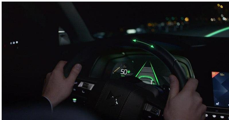
Hemos diseñado el DS DRIVE ASSIST para ayudar al conductor y permitirle retomar el control del coche en cualquier momento. Este sistema ajusta la velocidad y la distancia con respecto al vehículo que le precede y posiciona el DS 7 con precisión en su carril controlando la dirección si el conductor lo desea. Supervisa la velocidad y la dirección, garantizando la seguridad y la tranquilidad al volante.
