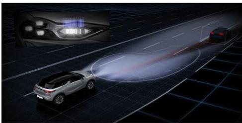
Los proyectores **DS MATRIX LED VISION** se componen de 3 módulos LED, así como de un módulo MATRIX BEAM dividido en 15 secciones independientes. Los segmentos se iluminan y apagan progresivamente, en función del entorno de conducción y de este modo, el conductor puede circular con las luces largas sin deslumbrar a los demás.
